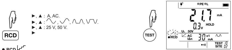
**Test de différentiel en mode impulsion / Test of residual current device in pulse mode / Fehlerstromschutzschalter-Prüfung im Impulsmodus / Test di differenziale in modo impulso / Prueba de diferencial en modo impulso**
