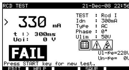
Esempio di risultati di misura di corrente d'intervento di un RCD
