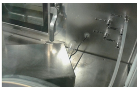
Fig. 2: posizionamento cella in glove box
