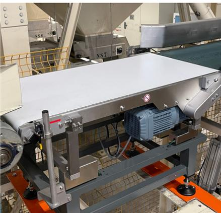
In accordo con il cliente e con il supporto tecnico di Minebea-Intec abbiamo optato per un taglio del nastro di confezionamento e l'inserimento della bilancia ponderale prima di una ghigliottina, collegandola al controllo di peso.
