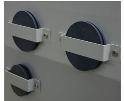
Protezione del foro di accesso in caso di sovrappressione per condizioni di prova stabili
