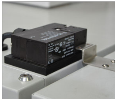
Dispositivo elettromeccanico di chiusura sportello comandato via programma e/o manualmente
